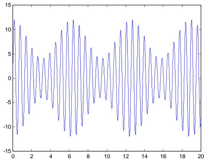
Die Amplitude des Trägersignals wird mit der Frequenz des akustischen Signals «moduliert», d. h. verändert. Verbindet man alle Maxima (oder Minima) des modulierten Trägersignals mit einer Kurve, so erhält man eine Kosinusfunktion mit der Amplitude der Seitenbänder und der Frequenz  $\Delta f$ . (Die Kreisfrequenz zu  $\Delta f = 1$  Hz ist  $2\pi$  rad/s.)
