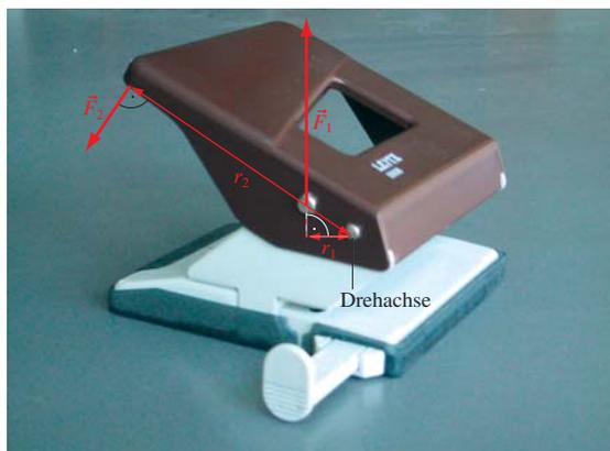
Im Bild sind die Grössen für das Drehmoment eingezeichnet. (Die Kräfte durch die Drehachse spielen keine Rolle, da sie kein Drehmoment erzeugen. Vernachlässigt wurde auch die Gewichtskraft des Drückers.) Es fällt sofort auf, dass der Kraftarm  $r_1$  zu den Stiften kürzer ist als der Kraftarm  $r_2$ . Im Gleichgewicht muss somit die Kraft  $F_1$  grösser sein als die Kraft  $F_2$ , mit der ich auf den Locher drücke.
